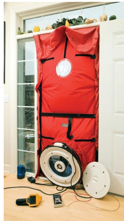
Blower Door Test
